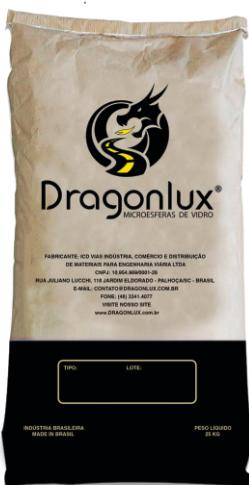
Las microesferas de vidrio Tipo I-B, comercializadas como Premix, están diseñadas para ser premezcladas con la pintura antes de su aplicación. La proporción recomendada es de, como mínimo, 250 gramos por litro de pintura. Estas microesferas permanecen en el interior de la película aplicada y permiten la retrorreflexión solamente después del desgaste de dicha película por la acción del tráfico. En ese momento, las microesferas de vidrio quedan expuestas.
